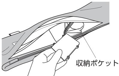
**3** 充電池カバーのネジ(4箇所)をドライバーを使ってはずします。
