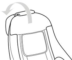
**5** 脚部カバーを手前に回します。脚用エアバッグが現れます。
