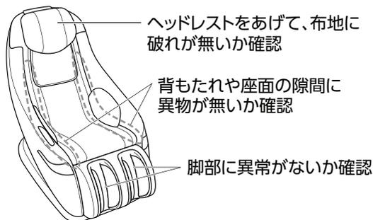
●モミ玉が収納位置にあるか、エアーが完全に抜けているか手で触れて確認
