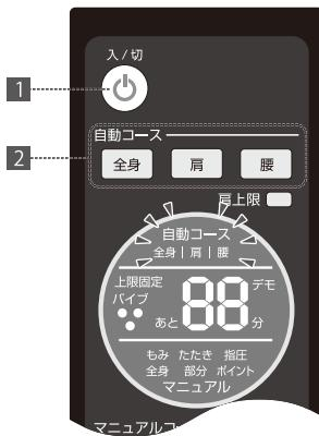
① 電源ボタンを押すと、電源ボタンと表示部のタイマー、仕切り線、フチ部分が青色に点灯し、もみ玉が一番上まで自動で移動します。(スタンバイモード)
