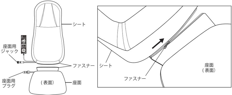
②シート側の座面用ジャックと座面側の座面用プラグの矢印マークを合わせて接続してください。
