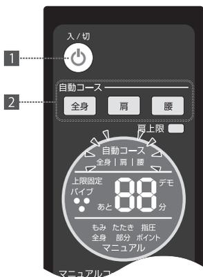
1 電源ボタンを押すと、電源ボタンと表示部のタイマー、仕切り線、フチ部分が青色に点灯し、もみ玉が一番上まで自動で移動します。(スタンバイモード)
