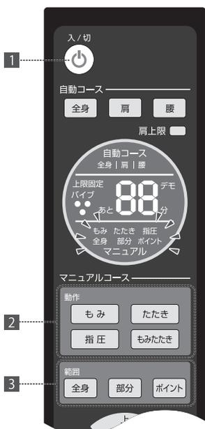
1 電源ボタンを押すと、電源ボタンと表示部のタイマー、仕切り線、フチ部分が青色に点灯し、もみ玉が一番上まで自動で移動します。(スタンバイモード)
