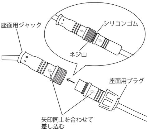
③座面用プラグ側のキャップを矢印の方向に回し、最後までしっかりと閉めてください。
