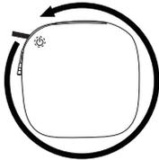
①表面カバーを外すときはファスナーの引手を持って反時計回りにゆっくり開けて取り外してください。
